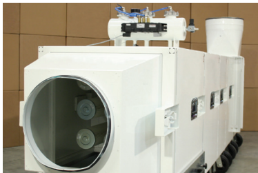
Modulfilter: Samlet længde 3,8 m.
